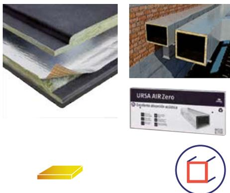
Painel de lã mineral URSA AIR em conformidade com a norma UNE EM 14.303 revestido com um complexo kraft-alumínio reforçado na face exterior e com o tecido acústico Zero na face interior. Sistema de macho/fêmea com o tecido interior Zero.
